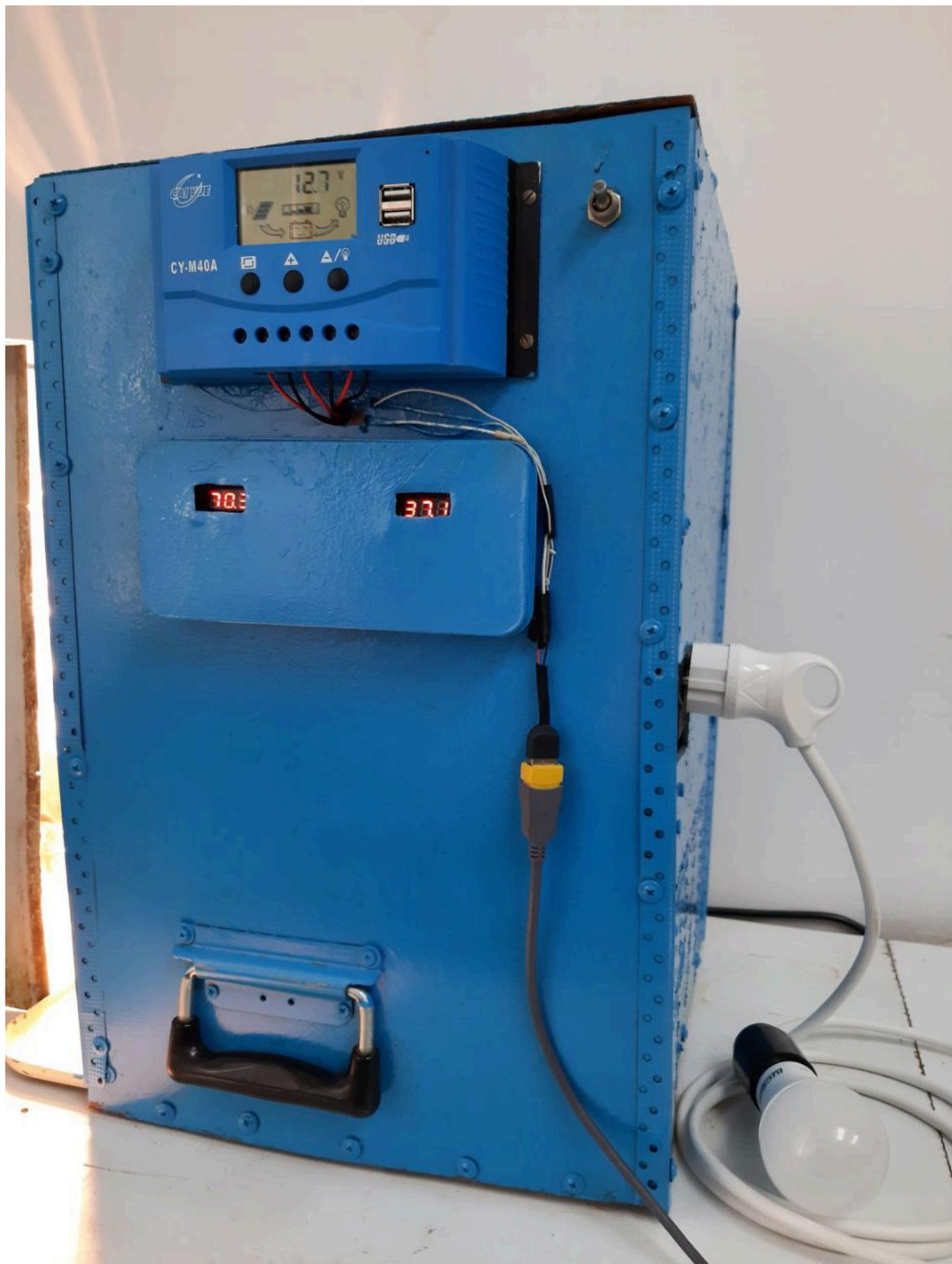
Termoelektrik generator qurilmasi zavod va kombinatlarning texnologik jarayonlarida paydo bo'ladigan issiqlikni elektr energiyasiga aylantirishga mo'ljallangan. Qurilma issiqlikdan elektr energiyasini ishlab chiqarishdan tashqari, issiq suv olish imkonini ham beradi.
