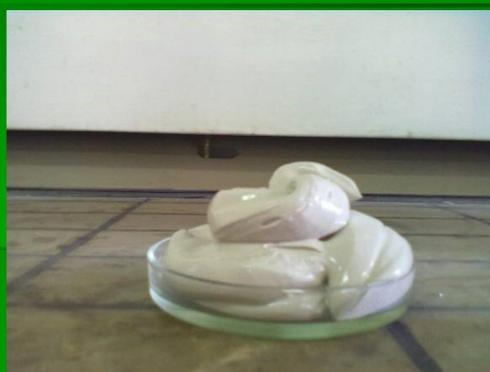
В целом, разработанный состав пасты смазочной эффективно снижает адгезию металлической поверхности форм к поверхности бетонных, железобетонных и пенобетонных изделий, что обеспечивает высокое качество поверхности изделий - без зажирений, темных пятен, раковин и других дефектов. Оставляет после себя гладкую поверхность, в результате чего отсутствует необходимость в дорогостоящей и трудозатратной финишной отделке. Кроме того, исключается
