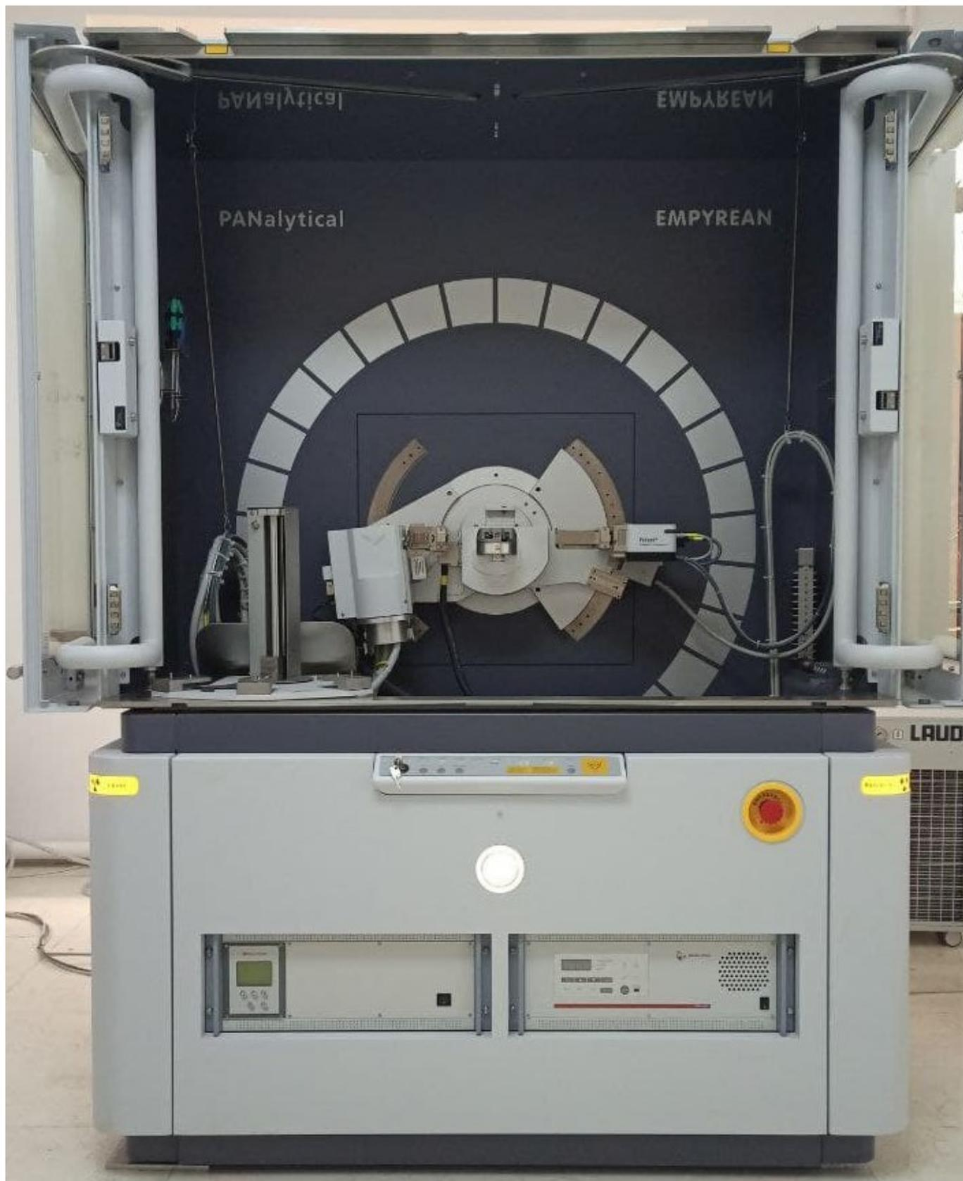
Многофункциональный рентгеновский дифрактометр Empyrean с вертикально расположенным гониометром и горизонтальным положением образца позволяет проводить следующие виды рентгенодифракционного анализа:
