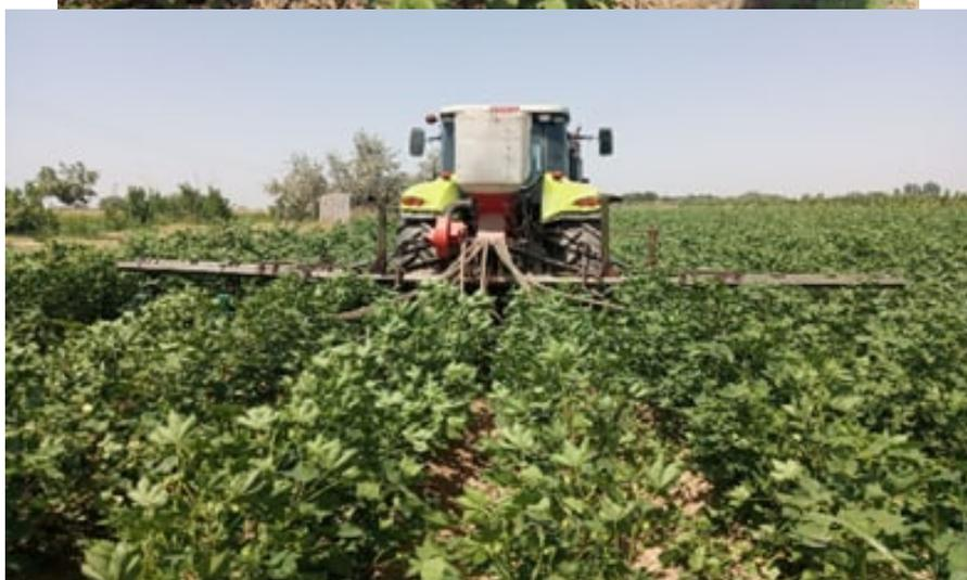
Культиватор КУ-8 со сборными боковыми рамами, регулируемым междурядьем (60, 76 и 90 см) обеспечивает полное использование коэффициента полезного действия (КПД) тракторов мощностью 150-200 л.с. При этом снижается общее количество используемых машинотракторных агрегатов. Конструкцию культиватора КУ-8 можно легко использовать на посевных линиях шириной менее 4 метров.
