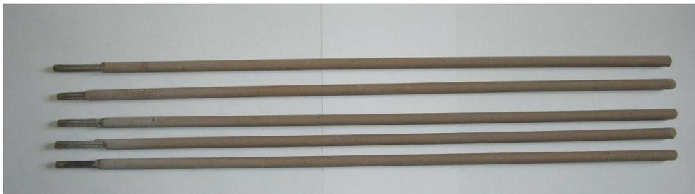
Разработанные составы покрытий позволяют использовать их при изготовлении сварочных электродов основного и кислого видов. В настоящее время они импортируются из России и КНР (марки УОНИ-13/55 и J422) для сварки углеродистых и низколегированных сталей. Разработанные институтом покрытия будут использоваться при изготовлении сварочных электродов на Ташкентском трубном заводе.
